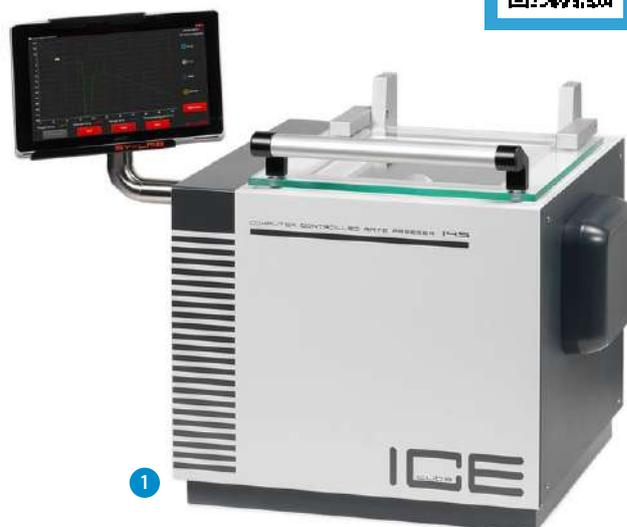
IceCube 14S с комплектом соединителей для контейнера с жидким азотом
